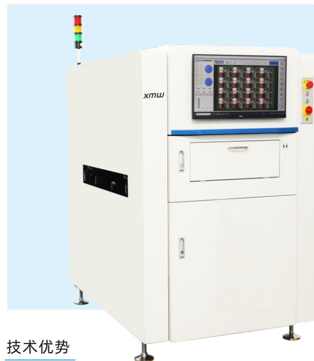
**在线PCBA贴片2D光学检测设备**
