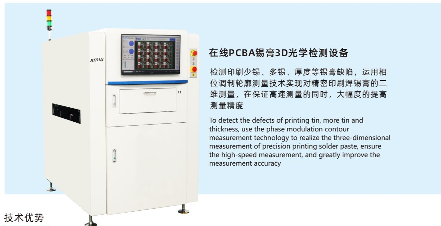
**在线PCBA锡膏3D光学检测设备**
